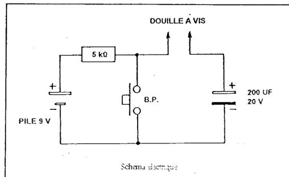
L'amorçage de l'ampoule est provoqué par le courant de décharge du condensateur de 200 uF lorsque le bouton poussoir est pressé ■
